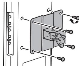
防犯モニター「**ミテマス mini**」や「**ミテマス Pro**」本体の向きを縦または横のいずれかに決めます。防犯モニターの裏面に取付金具を当て、付属のトラス小ねジ(M4x10mm)で4ヵ所すべてしっかり締めて固定します。
